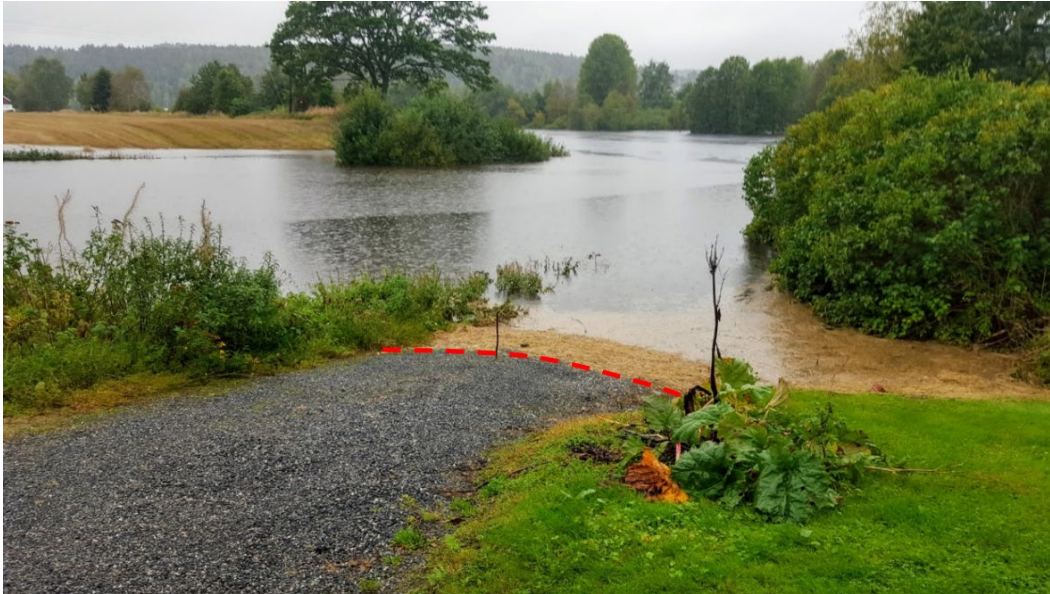
Figur 9-2 Eksempel på en gunstig lokalitet for å registrere vannstand (den røde stiplede linjen) til kalibreringsformål. Bildet er tatt 17. september 2015 av flom i Nidelva i Arendal kommune. Foto: NVE.
