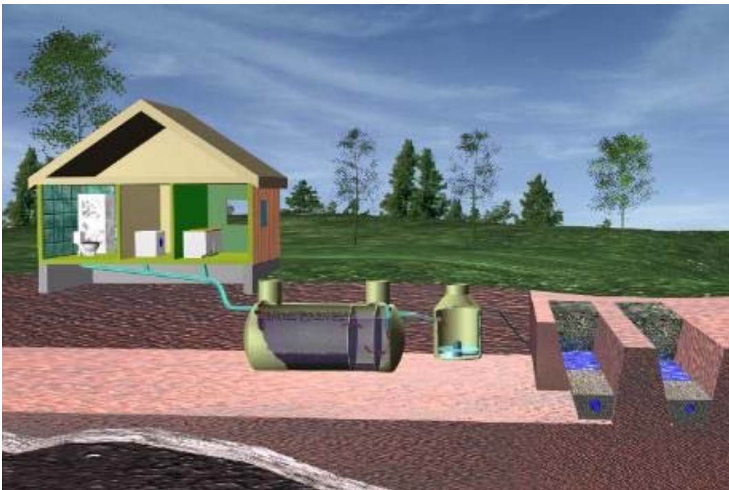
Fig. 1: Prinsippkisse av infiltrasjonsanlegg.
