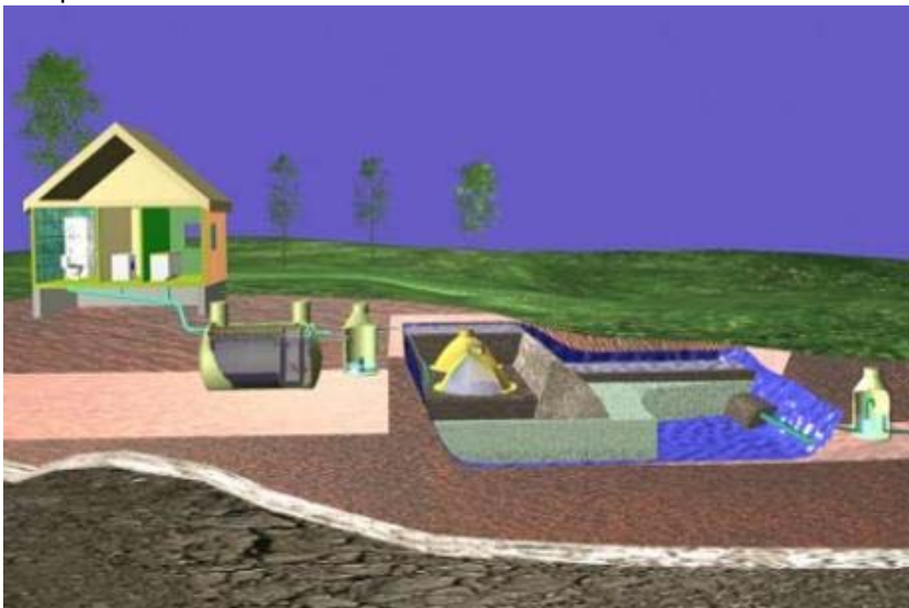
Fig. 4: Prinsippskisse av et filterbedanlegg.
