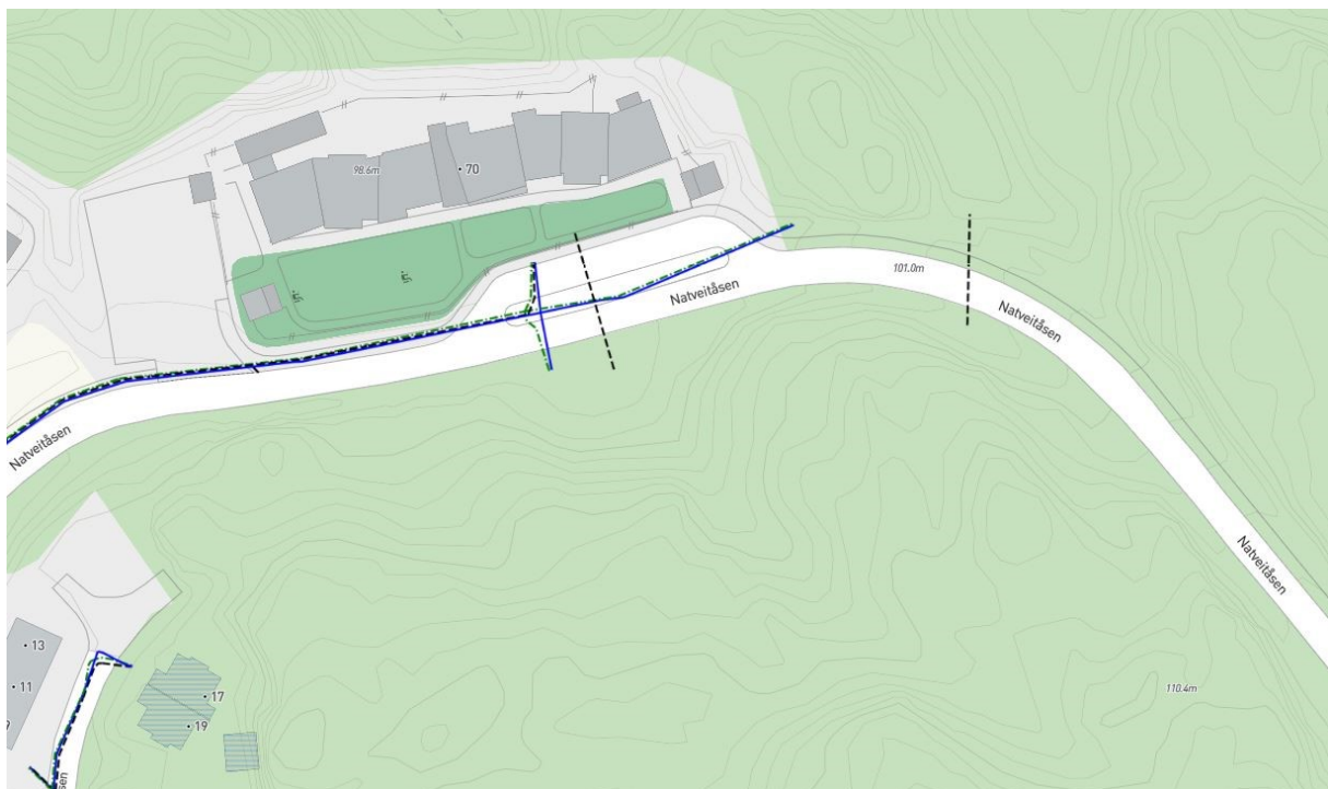
Figur 18 kartutsnitt, eksisterende VA- og overvanns-ledninger.
