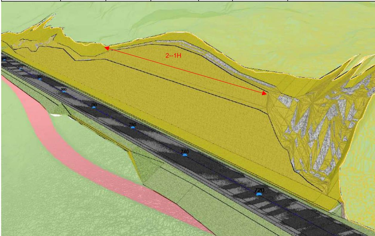
Figur 36: Pel 720 - ca. 800, omtrentlig plassering av skjæring 2-1H vist med rød pil (utklipp fra modell).
