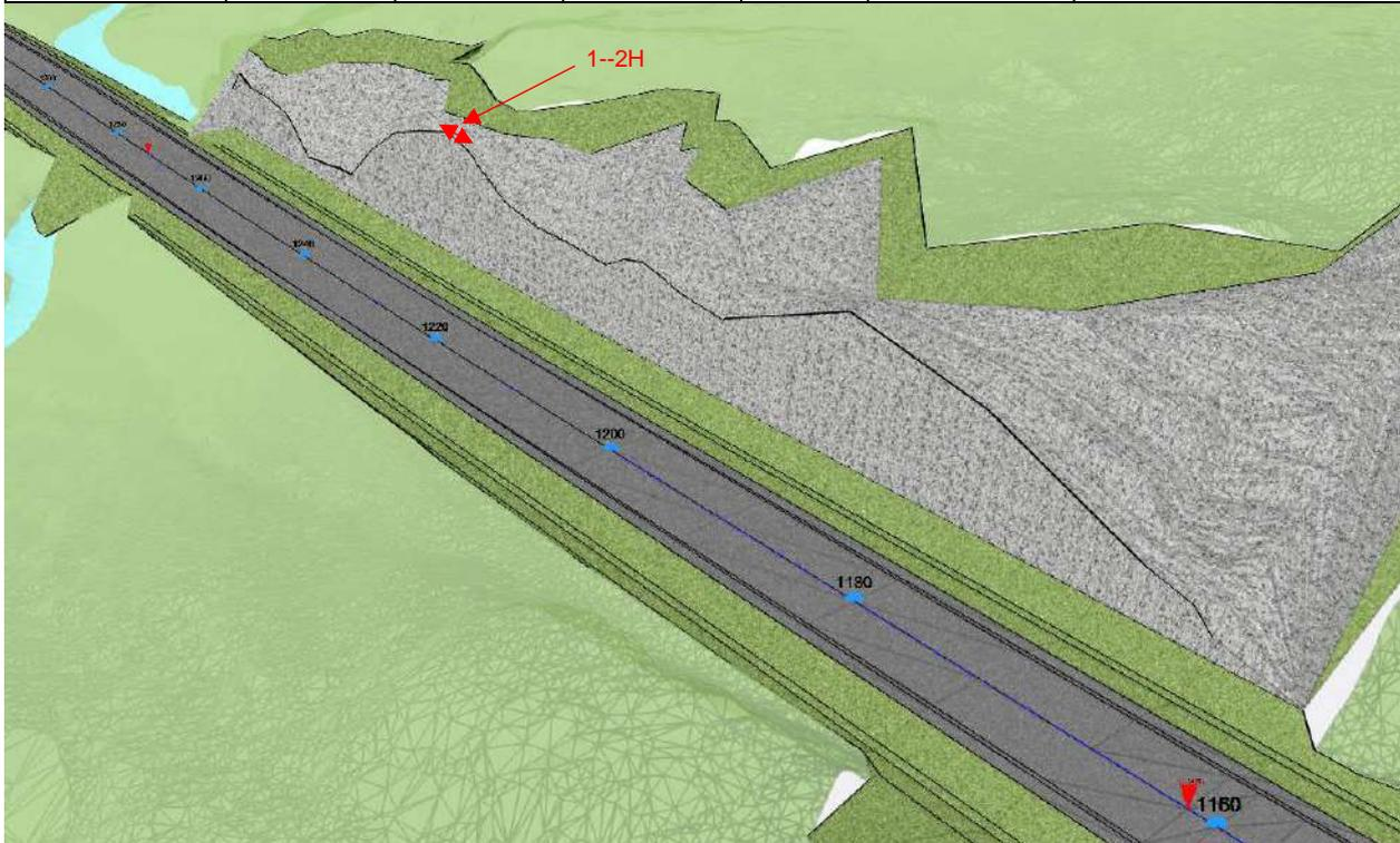
Figur 23: Bergskjæringer pel ca. 1160 - 1260, omtrentlig plassering av skjæring 1-2H vist med rød pil (utklipp fra modell).
