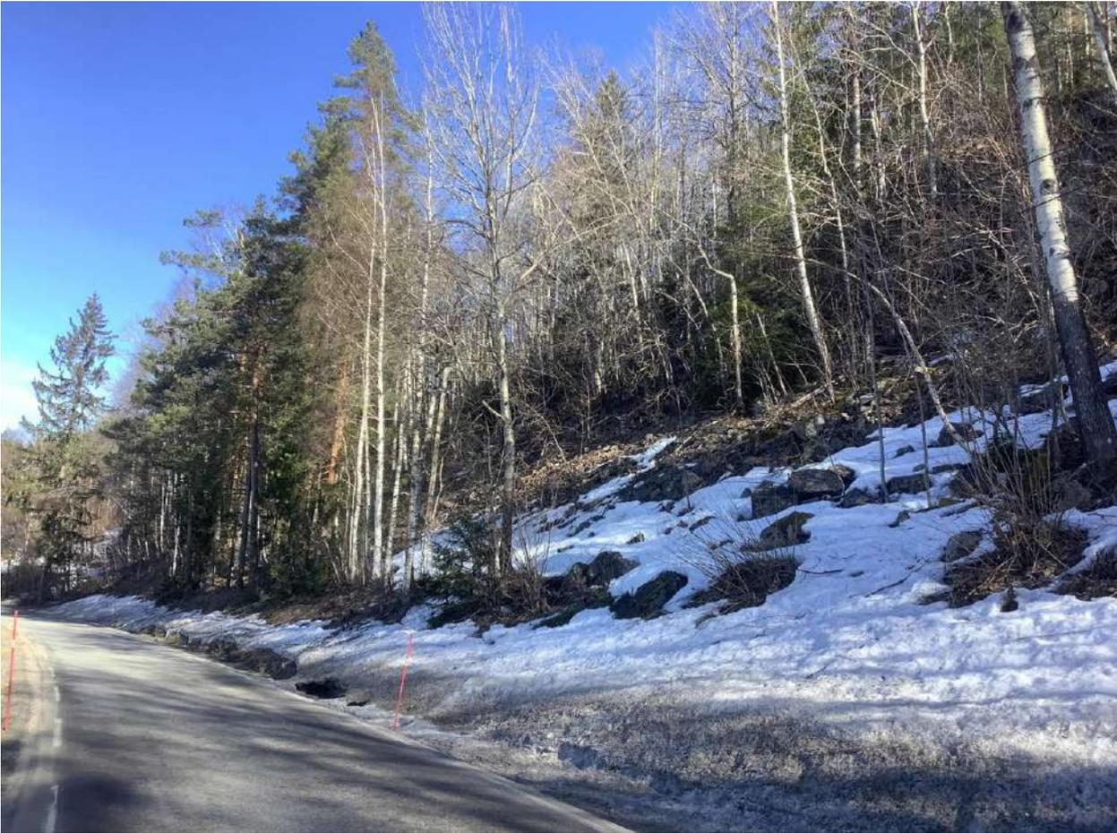
Figur 16: Det er registrert urmasser bestående av steinblokker med typisk størrelse ca. 0,1-0,3 m<sup>3</sup> helt ned til vegkanten mellom ca. profil 440-525. Bildet er tatt mot nord. Fotograf: Ingvild Sangesland.
