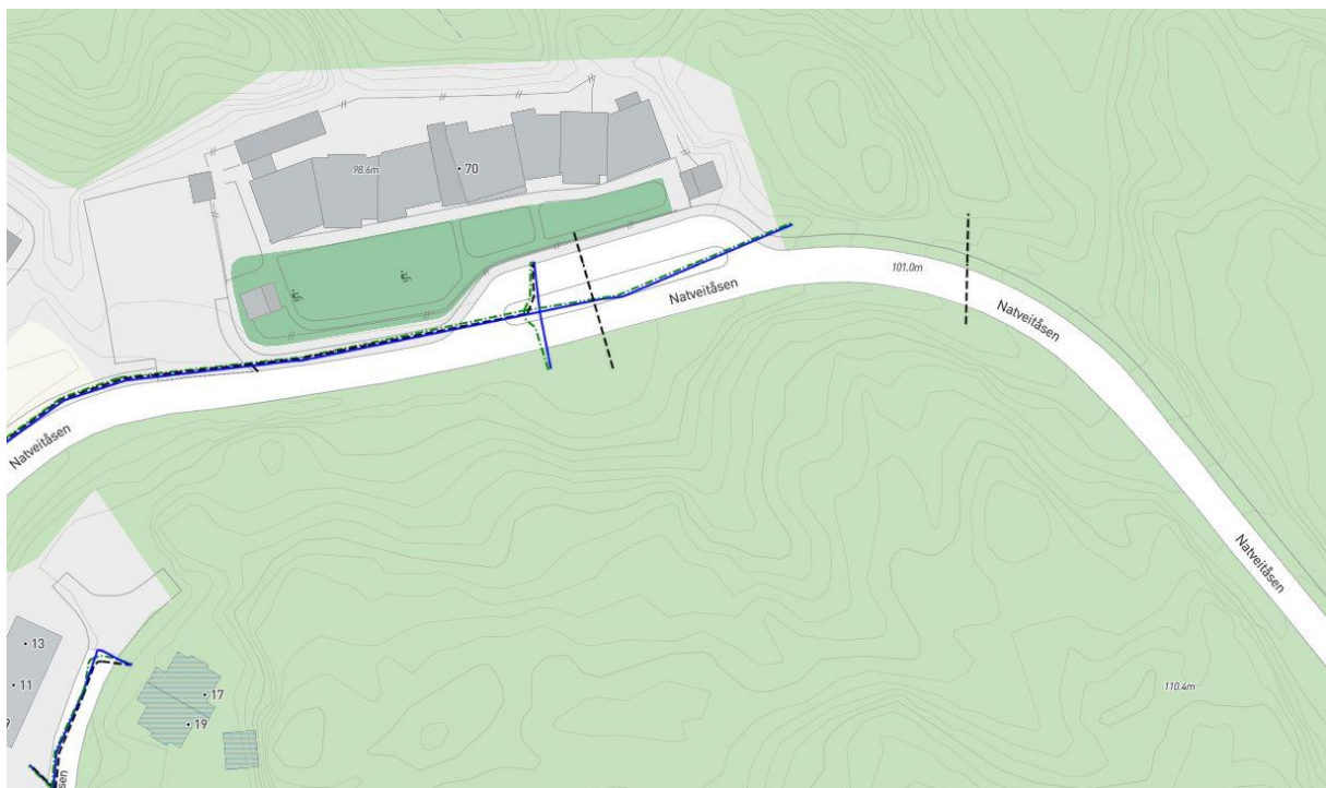
Figur 18 kartutsnitt, eksisterende VA- og overvannsledninger.
