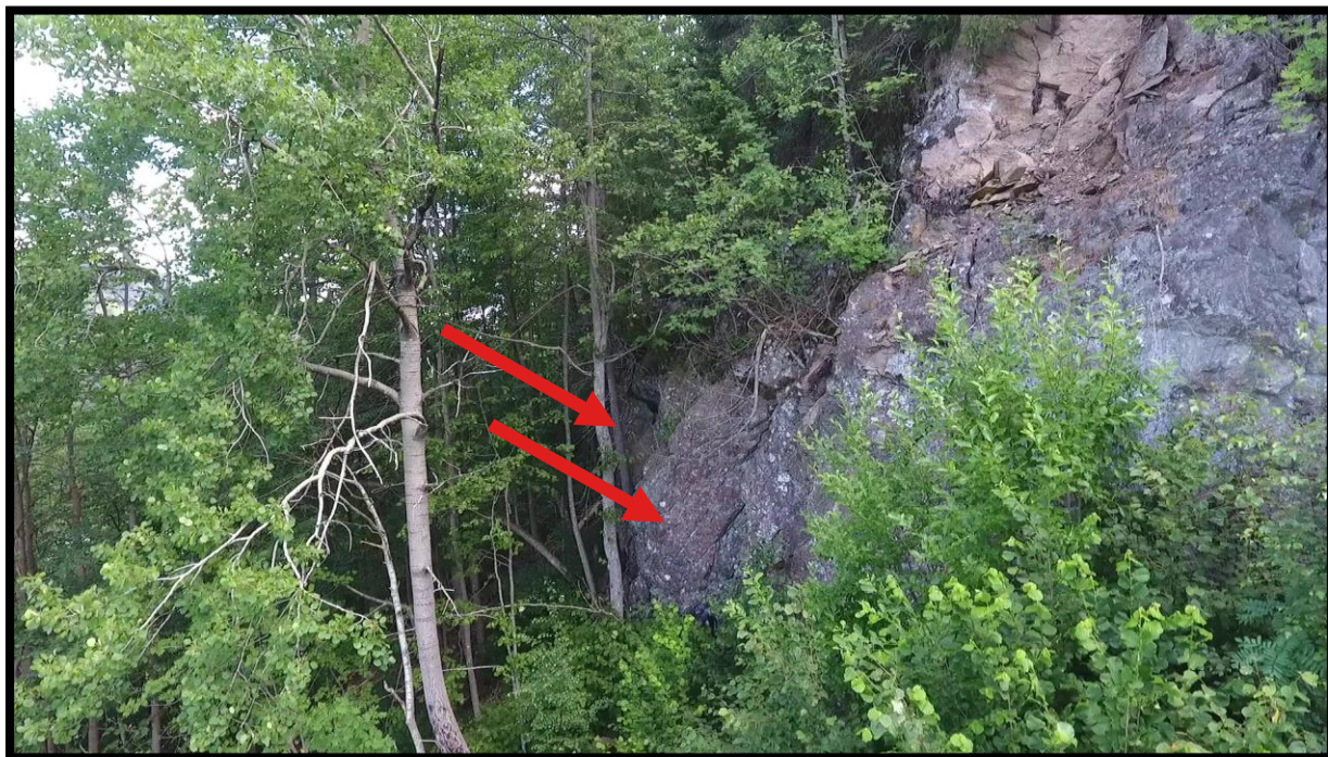
Figur 11. Delvis avløste blokker med steilt fall mot vegbanen.
