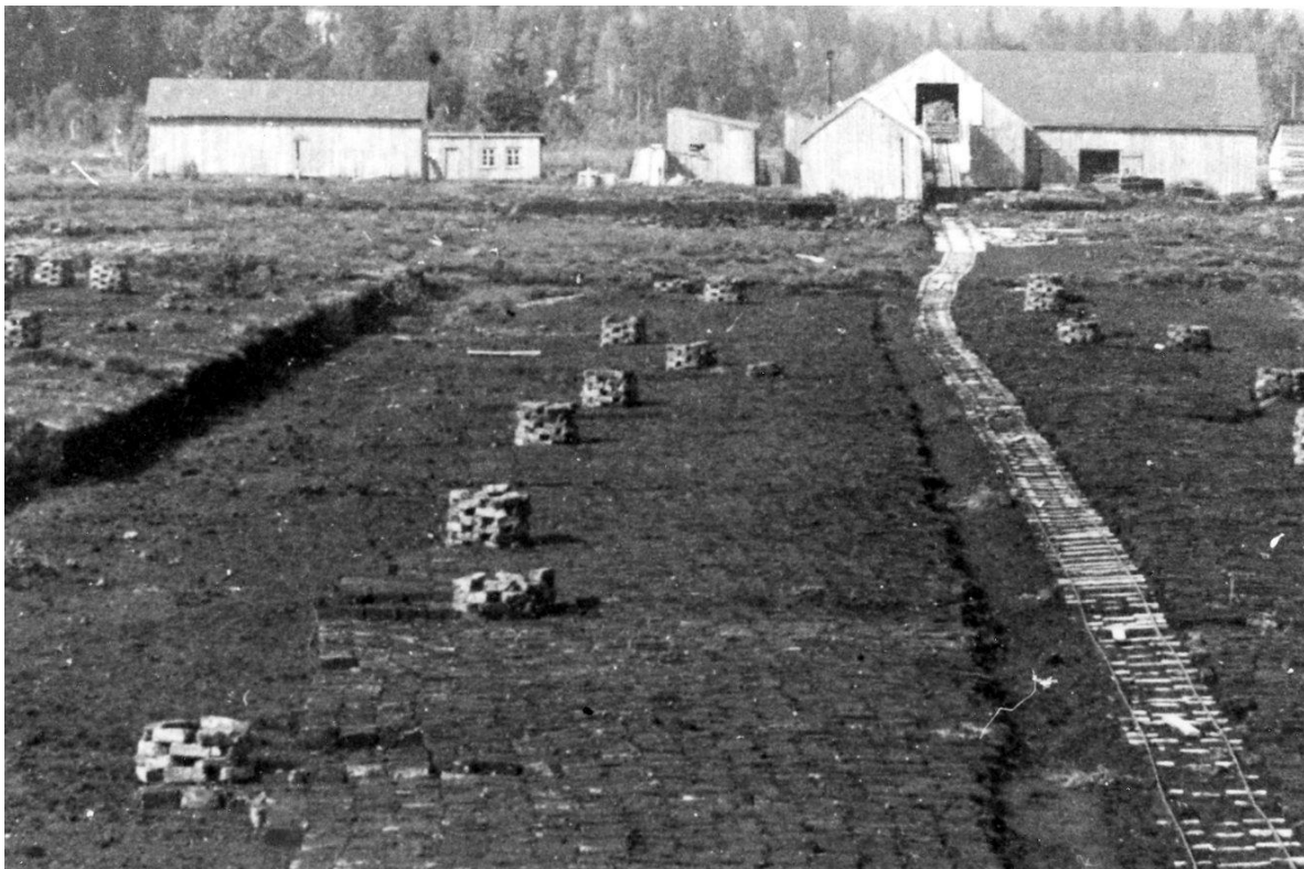
Torvmyra med fabrikkbygningene i bakgrunnen. Til venstre ser vi ei torvskjærergrøft. Til høyre for midten ses Holmebanen ved siden av ei grøft med nyopplagte torver. Vi ser noen påbegynte torvstapler på begge side av banen.
