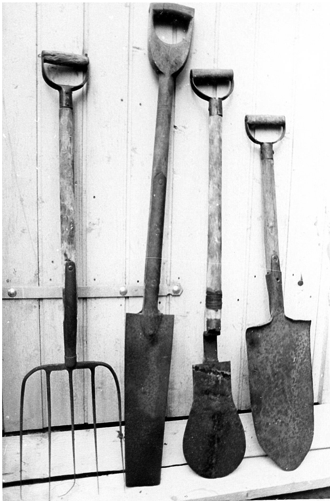
Torvskjærer redskaper. Fra høyre: Avstikker-spade. Torvskjærer-spade. Holdike-spade for å få vannet vekk. Greip til å lempe torva inn på myra.
